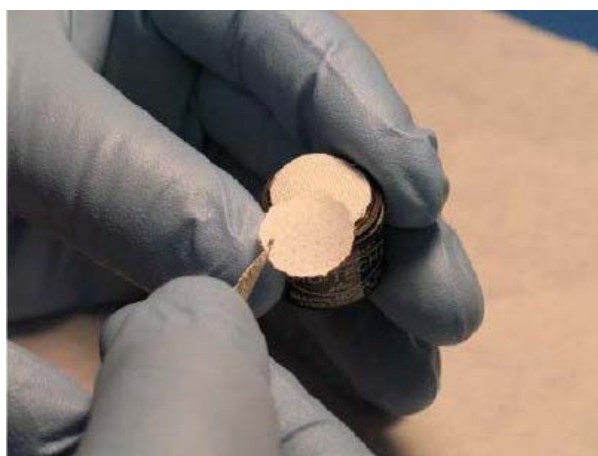
Рисунок 28 Установка наполнителей фильтра
