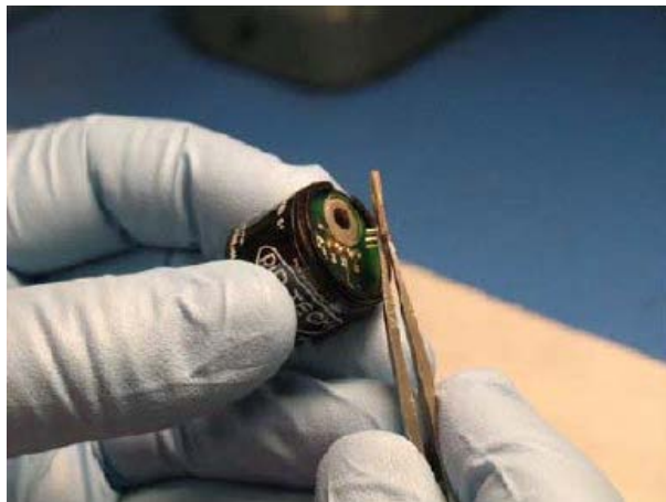
Рисунок 26 Установка модуля ячейки
