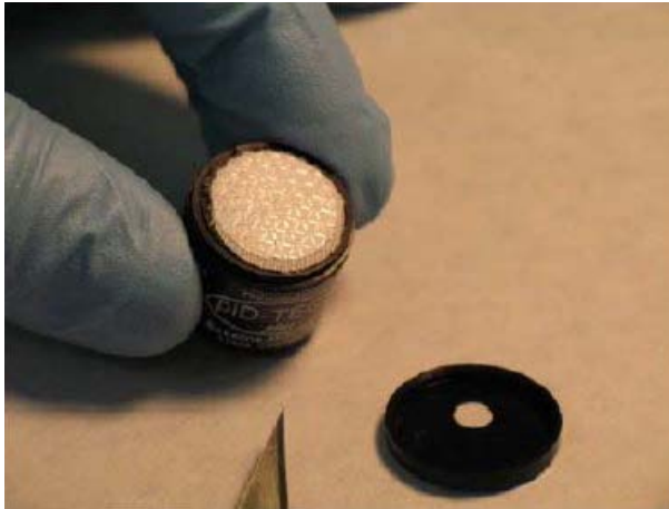
Рисунок 18 Снятие наполнителя фильтра
