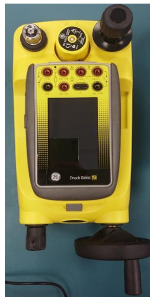
Рисунок 9 – Общий вид калибратора DPI 620G, исполнение DPI 620G-IS на устройстве создания давления PV621G-IS, PV622G-IS, PV623G-IS
