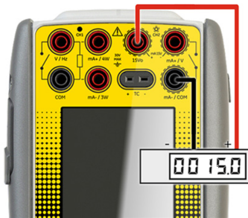
Рис. 2-15. Подключение к выходу нерегулируемого токового контура 15Vo
