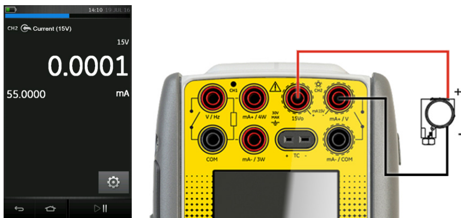
Рис. 2-16. Измерение силы тока в канале 2 с питанием от внутренней цепи 15 В, диапазон \pm 55 мА
