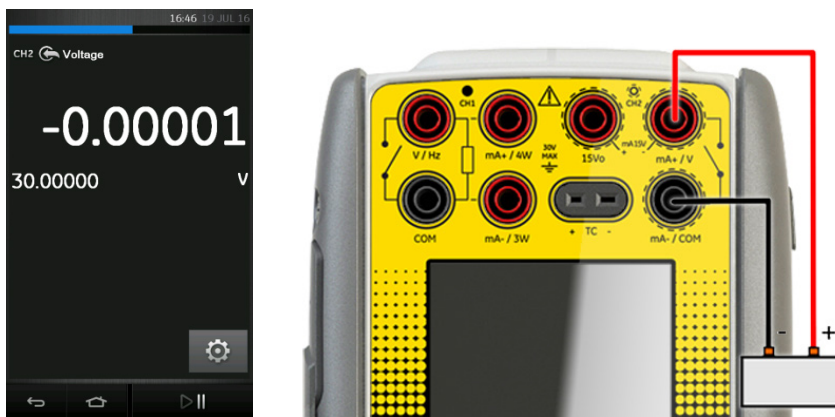
Рис. 2-19. Измерение постоянного тока в вольтах или милливольтмах в канале 2, диапазон \pm 30 В
