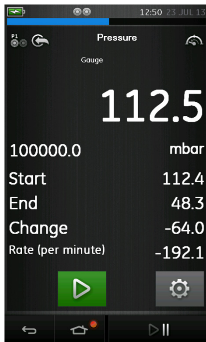
Рис. 3-10. Пример проверки на утечки
