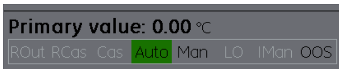
Рис. 8-21. Строка заголовка блока с основным значением
