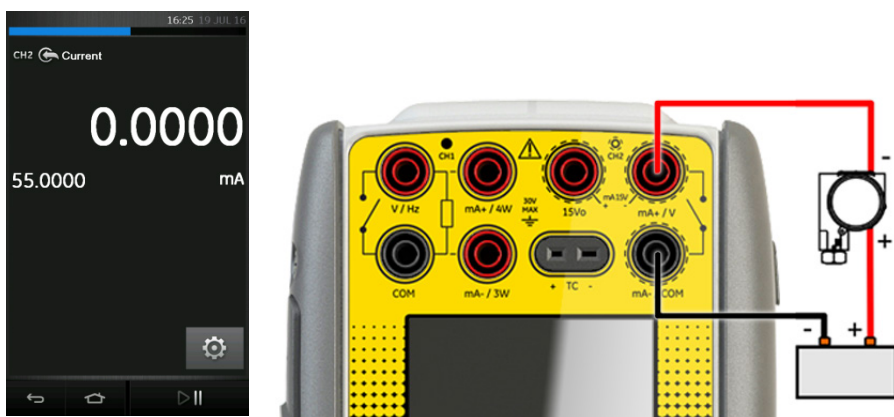
Рис. 2-14. Измерение силы тока в канале 2, диапазон \pm 55 мА
