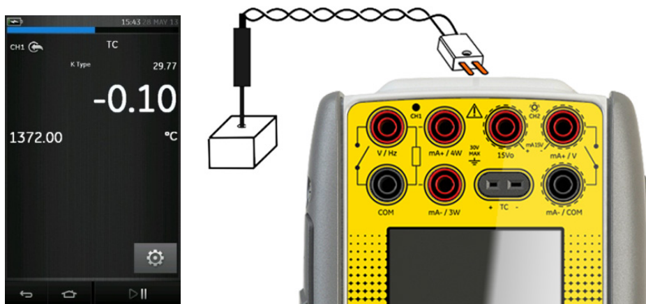
Рис. 2-27. Измерение температуры по терморезистору типа К в канале 1 (диапазон от -270 до 1372 °С)
