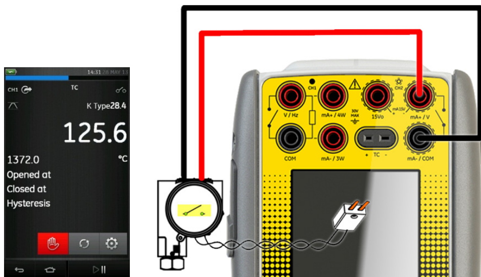
Рис. 2-30. Поиск источника термопары в канале 1, проверка при включении в канале 2
