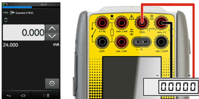
Рис. 2-17. Источник тока в канале 2 с питанием от внутренней цепи 15 В, диапазон от 0 до 24 мА
