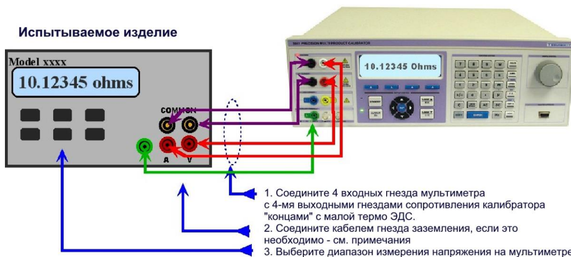
Подсоединение испытываемого устройства при 4-х проводной схеме подключения выхода сопротивления
