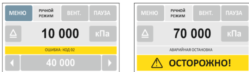
Рисунок 4.1 - Окна в состоянии "ошибка" и в состоянии "аварийная остановка"
