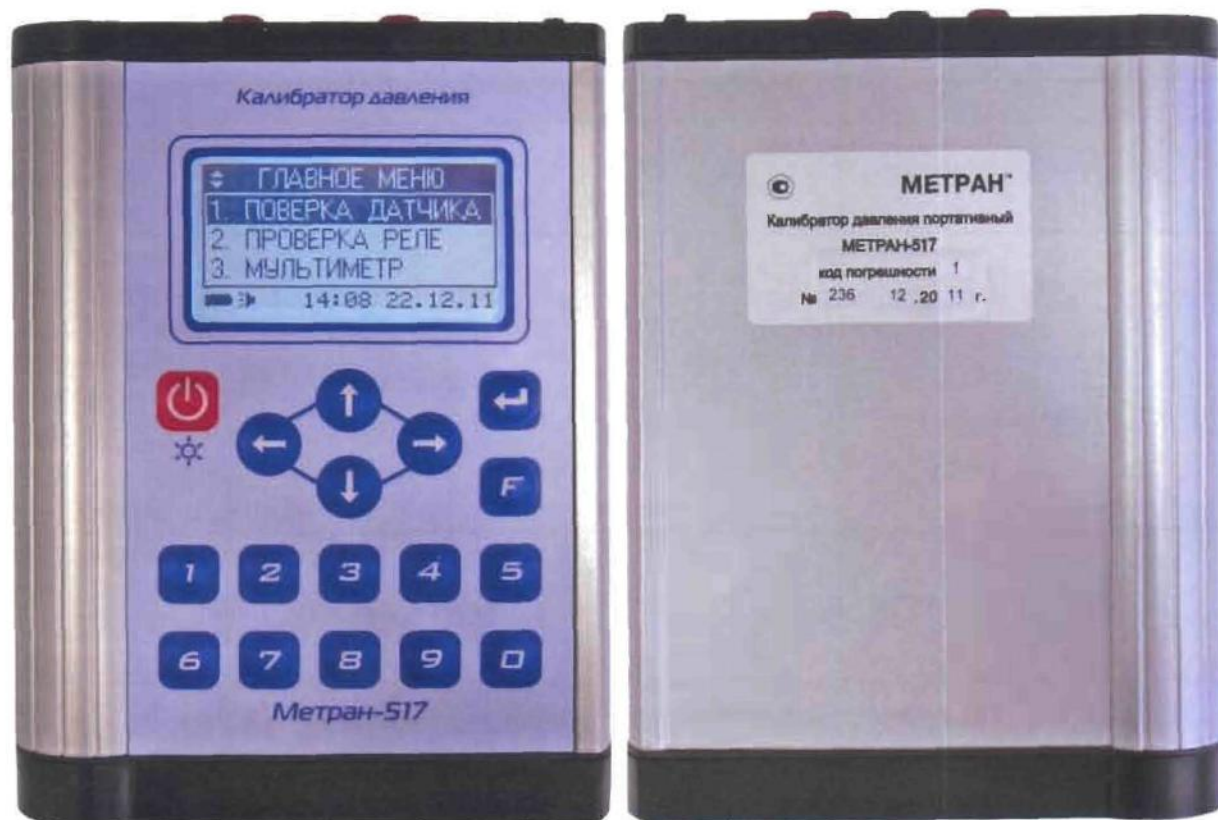
Рисунок 1 - Внешний вид калибратора Метран-517
