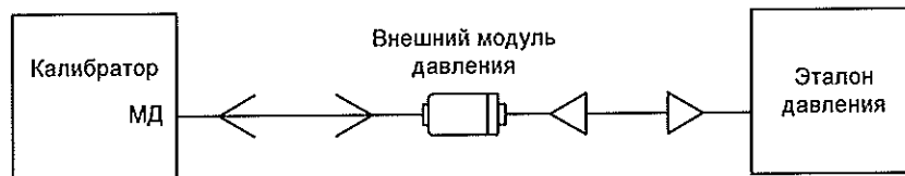
Рисунок А.2 – Схема поверки калибратора в режиме измерений давления внешним модулем давления
