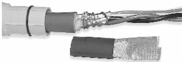
Рисунок 1-8. Обвязка экранированных проводов утечки
