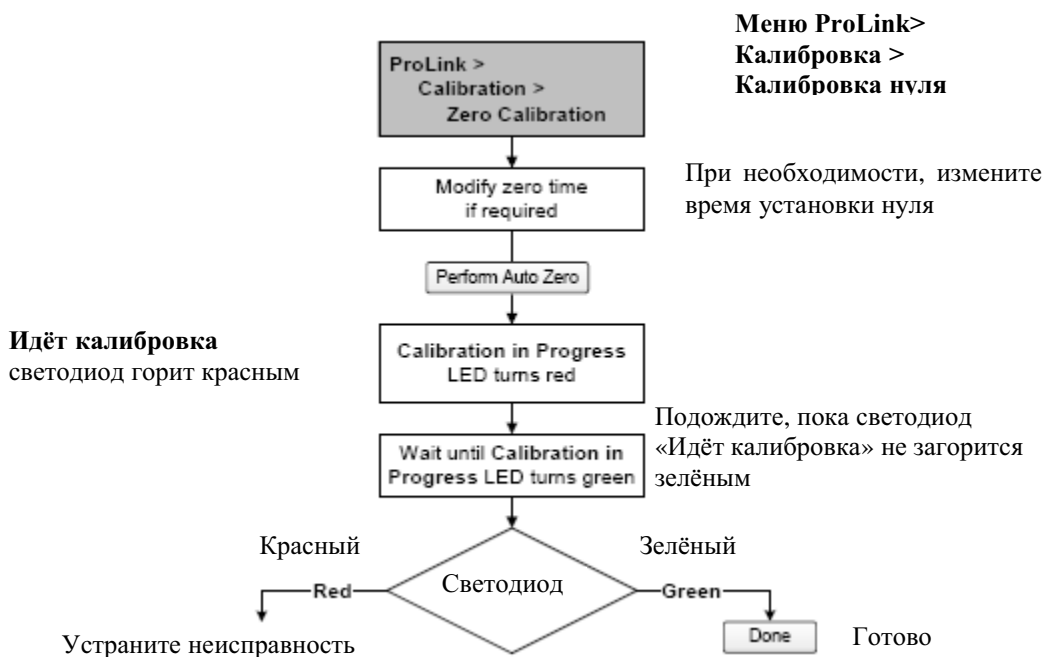
Рисунок 5-4 Процедура установки нуля расходомера с помощью ProLink II
