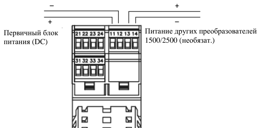
Рисунок В-5 Клеммы источника питания - Модель 1500/2500
