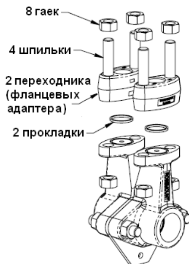
Рис. А.5. 1195 с переходниками для удаленного монтажа трансмиттера
