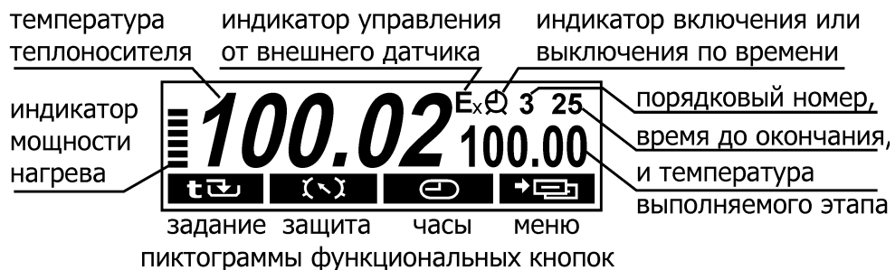
Рисунок 5 — Дисплей в режиме регулирования по программе
