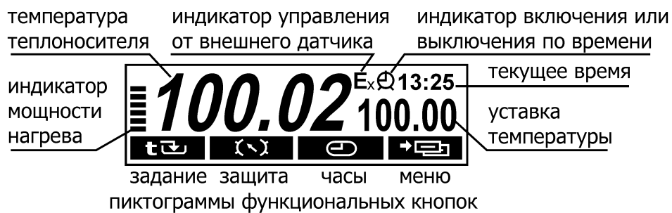
Рисунок 4 — Дисплей в режиме регулирования по уставке
