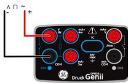
Рисунок Б.8 Измерение частоты на канале 1. Диапазон: от 0 до 50 кГц. Порог переключения: 2,5В.
