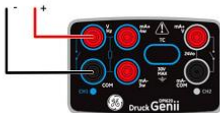
Рисунок Б.5 Генерация напряжения постоянного тока (От 0 до 12 В); в милливольтках (от 0 до 2000 мВ) на канале 1
