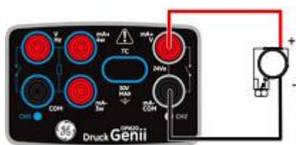
Рисунок Б.6 Измерение тока ( \pm 55 мА) на канале 2 (CH2) +внутренний контур питания (24 В)
